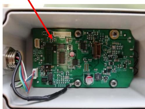
Alternativ, se va conecta un rezistor 120  $\Omega$  intre pinii 2 si 4 ai conectorului A.
